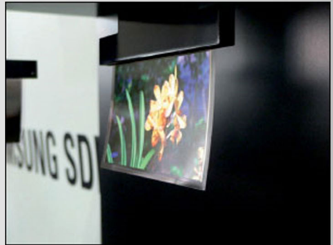
شکل 2: OLED شرکت سامسونگ که تنها نیم میلیمتر ضخامت دارد
